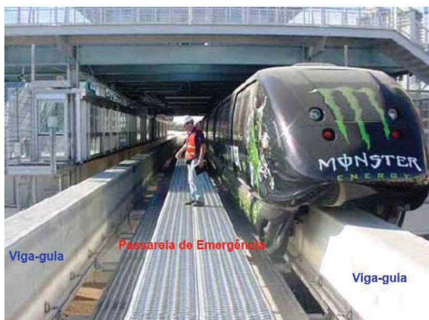
Foto 7.3.2.1-1: Vigas-guias paralelas e “passarela de emergência”
